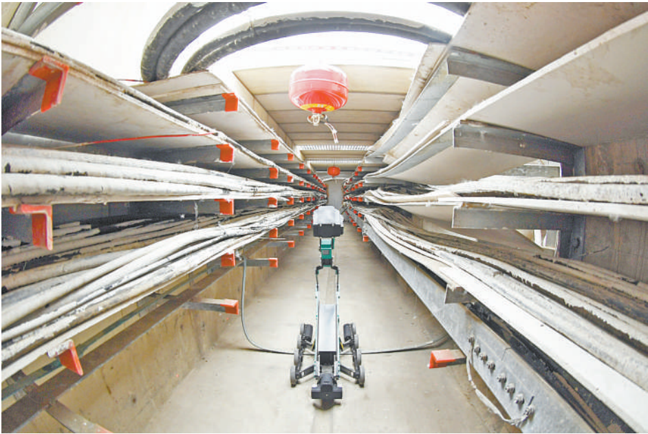
近日,在1000千伏特高压淮南变电站,多功能智能机器人正在巡视地下电力设备。此举弥补了运维人员无法巡视地下电力设备的短板,提升了巡检效率,确保华东电网安全稳定运行和夏季居民可靠用电。宋卫星摄(中经视觉)
