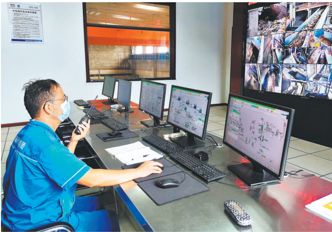
湖北宜昌葛洲坝当阳水泥有限公司水泥窑协同处置生活垃圾和污泥项目车间内,操作人员通过电脑操控设备,对垃圾进行预处理。
