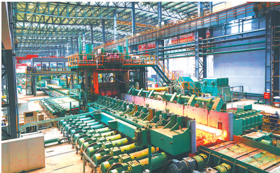
中国一重承制的国内首套重型H型轧机一次热负荷试车成功。 陈建军摄(中经视觉)
