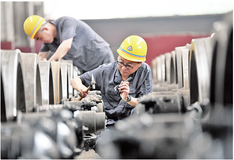
中国铁路郑州局集团有限公司郑州车辆段工人在检查旅客列车车轮。进入盛夏,炎热的天气对设备维护带来了更大挑战。郑州局集团依托信息化管理手段,采取磁粉探伤和超声波探伤的形式,判断车轮“健康”状况,消除故障隐患,保障列车运行安全。 赵庆摄(中经视觉)
