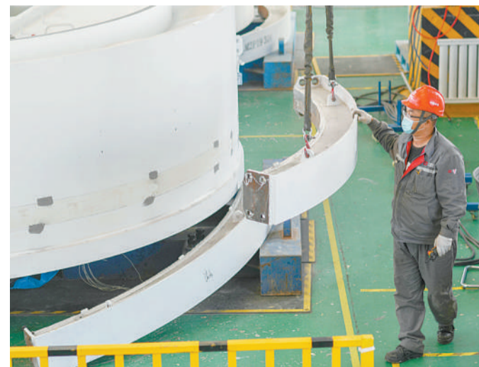
在哈密中车新能源电机有限公司生产厂房，工人安装直驱永磁风力发电机。 新华社记者 赵戈摄
