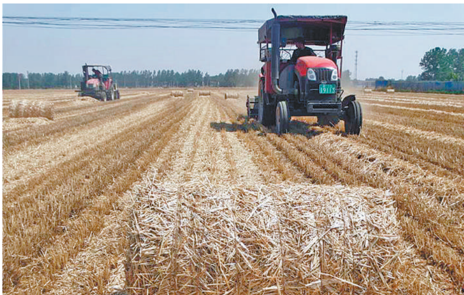
在河南省沈丘县周营镇东李营村一处机收后的麦田里,打捆机在捡拾秸秆进行自动打捆作业。
