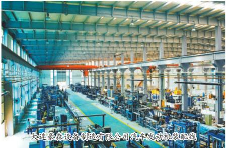
大连装备制造制造有限公司汽车发动机装配线
