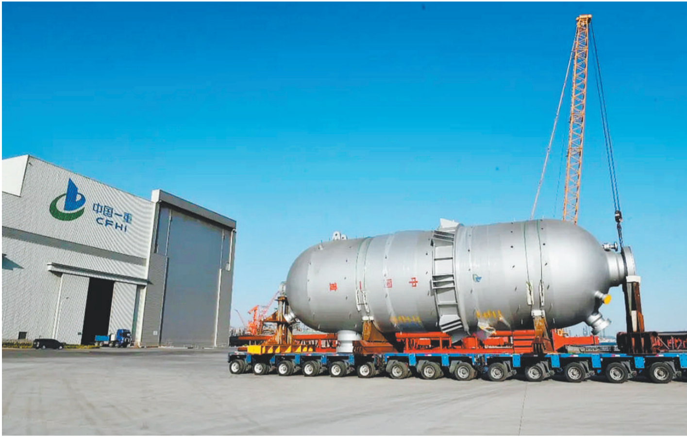
近日,中国一重大连石化公司承制的浙江逸盛锻焊加氢反应器套容器设备顺利完成制造任务。(本报记者 苏大鹏供图)
