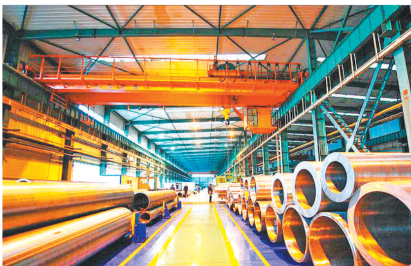
北重集团生产的电站用厚壁无缝钢管。(企业供图)
