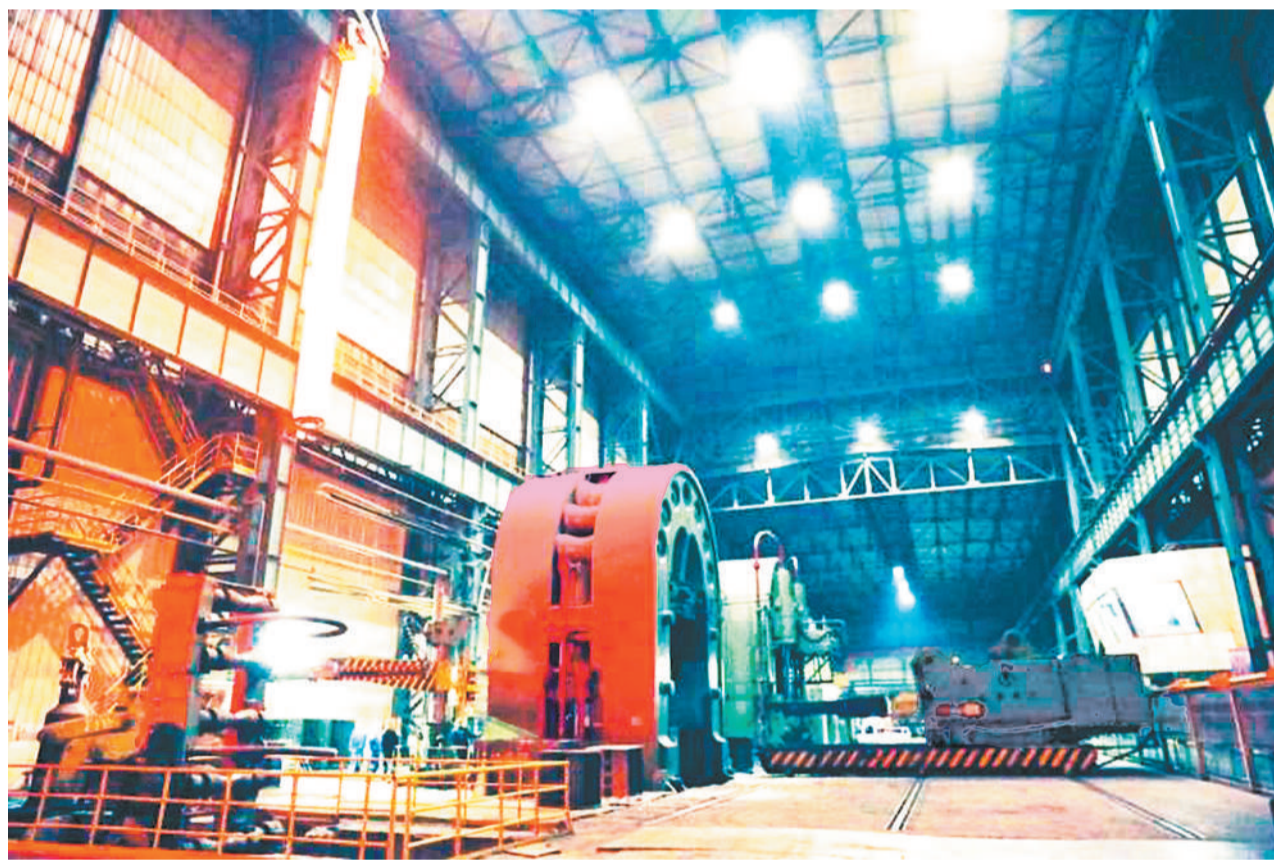
北重集团黑色金属垂直挤压压机正在挤压厚壁无缝钢管。(企业供图)
