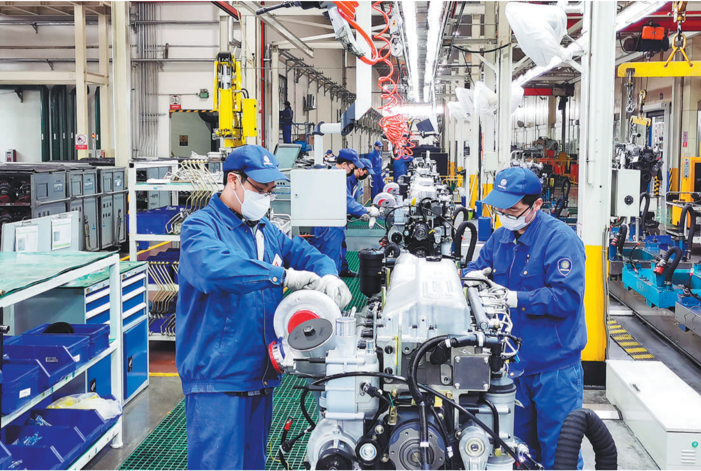
图为潍柴动力一号工厂总装车间里，一线工人正在装配发动机。
