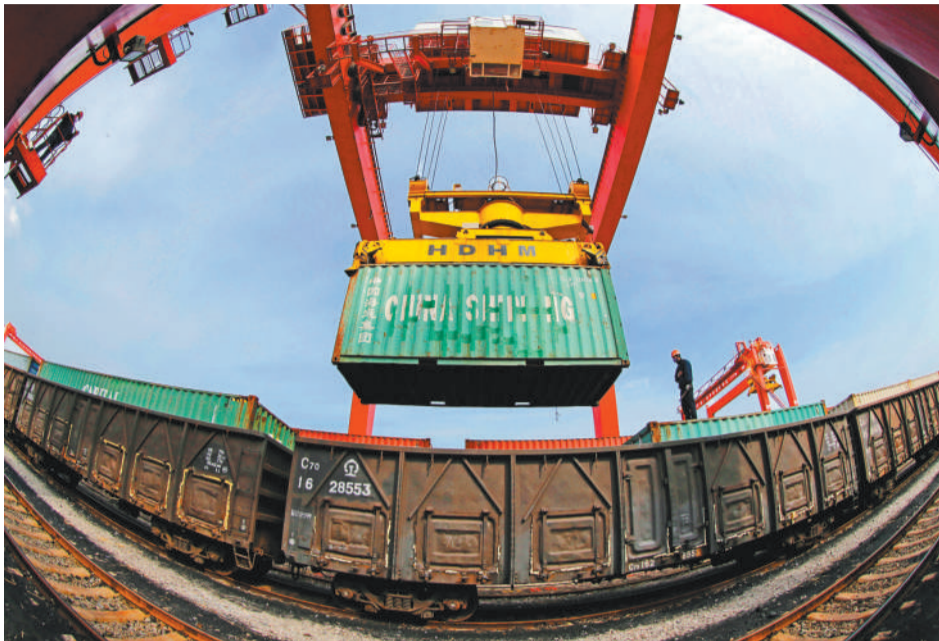
日前,在江苏连云港中哈连云港物流合作基地场站,工人正在操控龙门吊车吊装出口集装箱。
