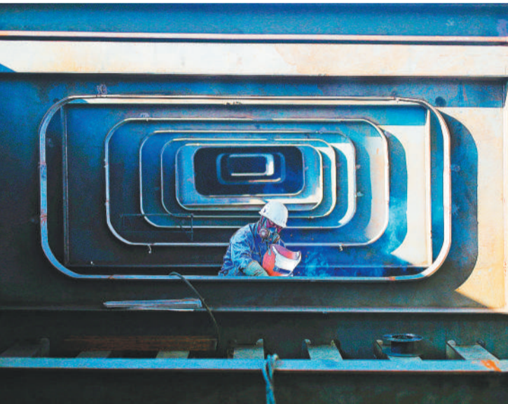
上图 2月20日，山东临沂市沂南县东岳机械股份有限公司员工在安装大型免烧砖机。
