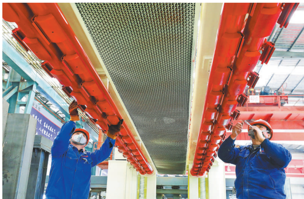
上图 2月20日，山东临沂市沂南县东岳机械股份有限公司员工在安装大型免烧砖机。
