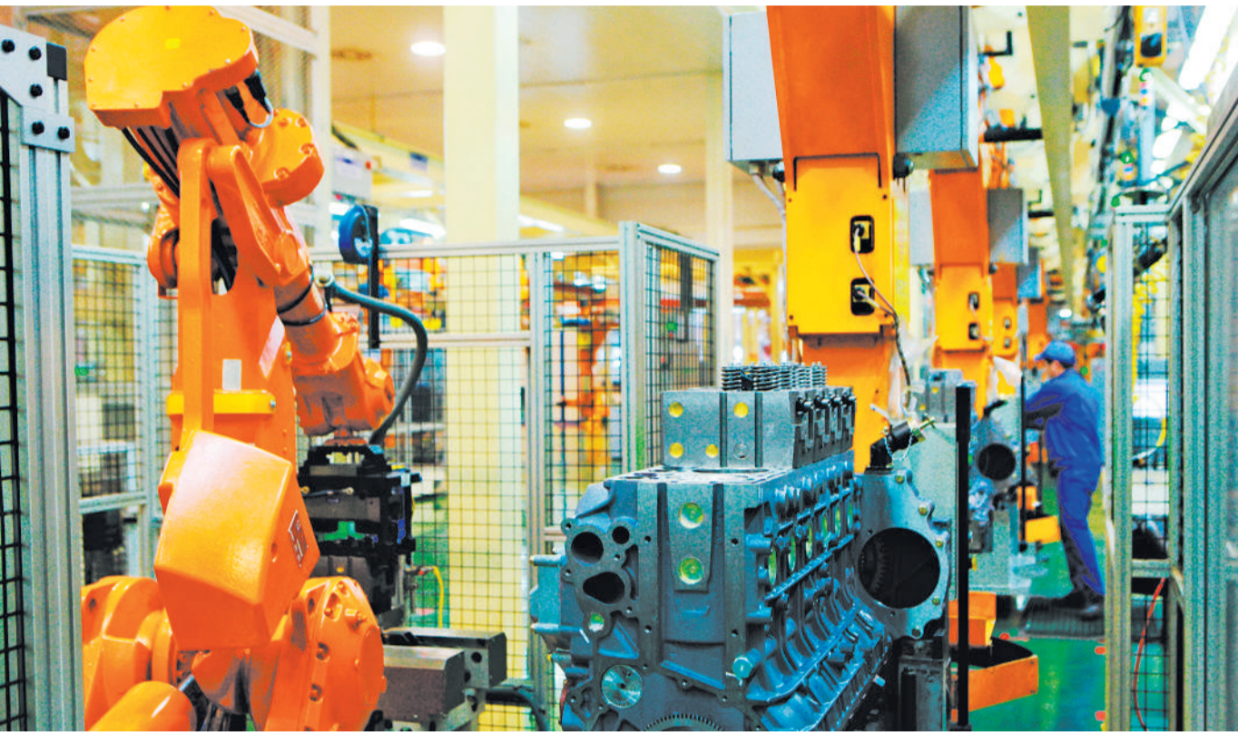
潍柴二号工厂总装车间,机器人正在装配发动机缸盖总成部件。
