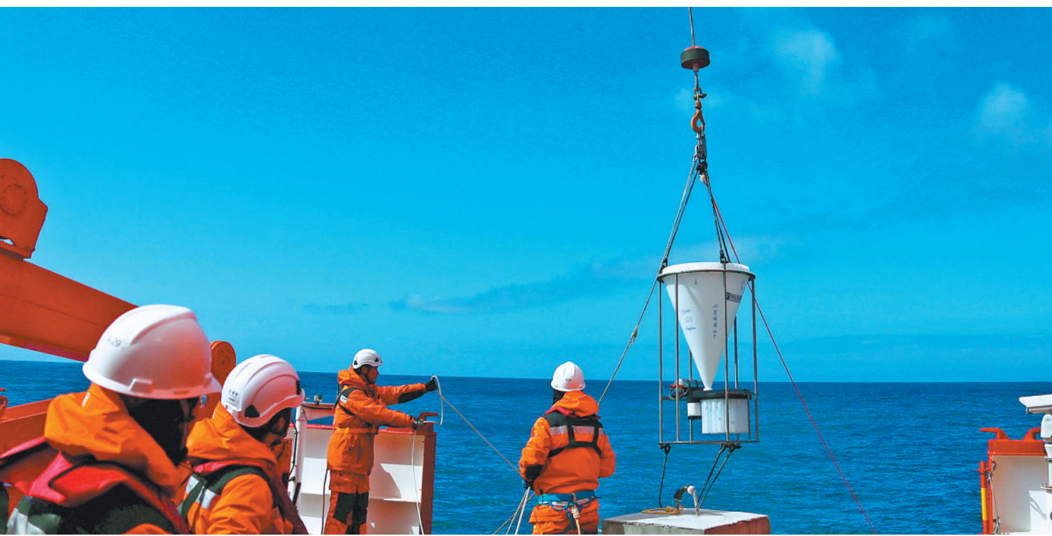
「雪龙二」号探访宇航员海 一月五日,「雪龙二」号上的科考队员在布放时间序列沉积物捕获器。中国第三十六次南极考察队队员五日首次用大型底栖生物拖网在宇航员海开展底栖生物调查。 新华社记者 刘诗平摄
