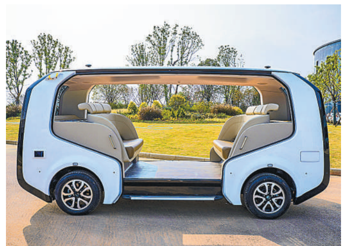
东风公司研制的首款融合5G远程驾驶技术的无人驾驶小巴Sharing-VAN,没有方向盘、油门和刹车,车内如同客厅。张敏摄
