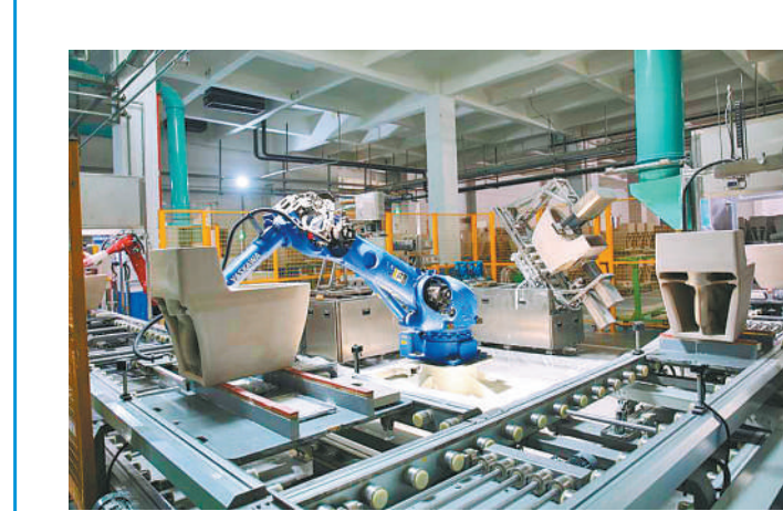
日前,在九牧集团智能工厂里,机器人正在为智能马桶坯体施釉。徐 婷摄
