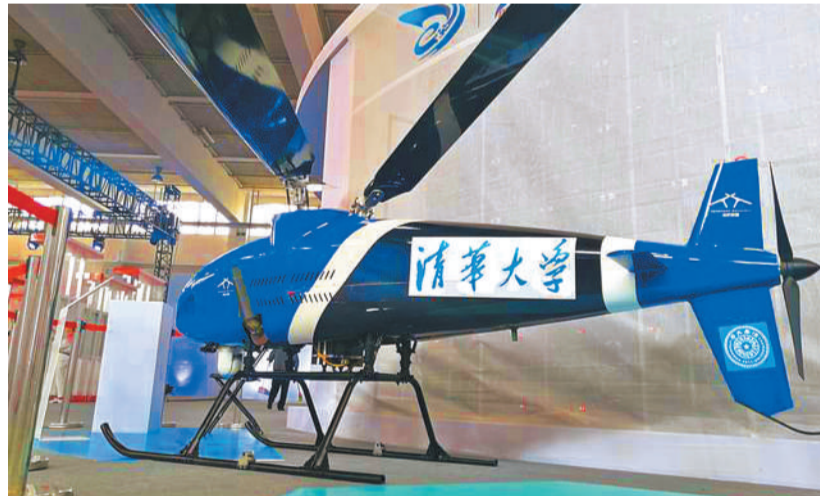
在第五届中国“互联网+”大学生创新创业大赛上,清航装备团队研发的交叉双旋翼无人直升机。
