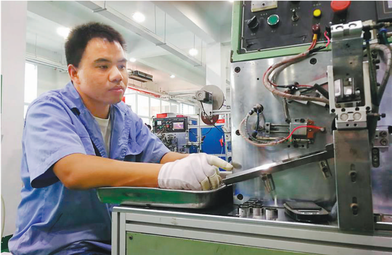
在申科互感器车间，员工正在使用绕线机绕制半成品互感器。
