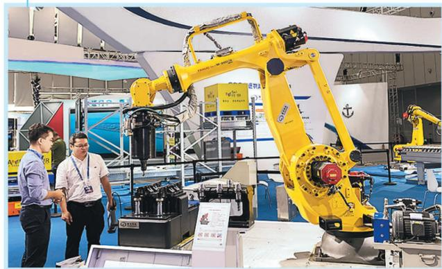
图为广东鑫光智能系统有限公司推出的机器人搅拌摩擦焊系统。 本报记者 鹿彩霞摄
