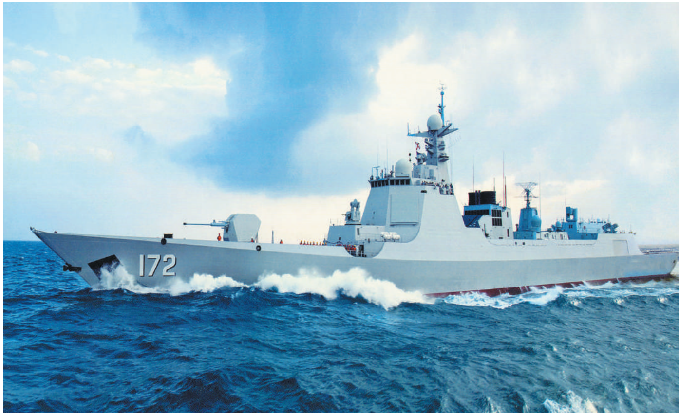
“中华神盾”舰主战雷达装备“海之星”是世界首部列装的舰载有源相控阵雷达。
