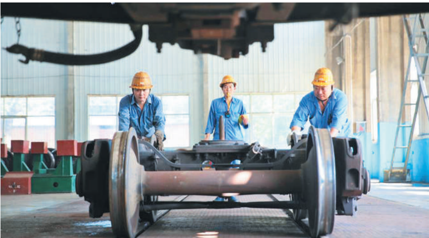
图为职工更换完列车轮对后,将转向架推送至列车底部。
