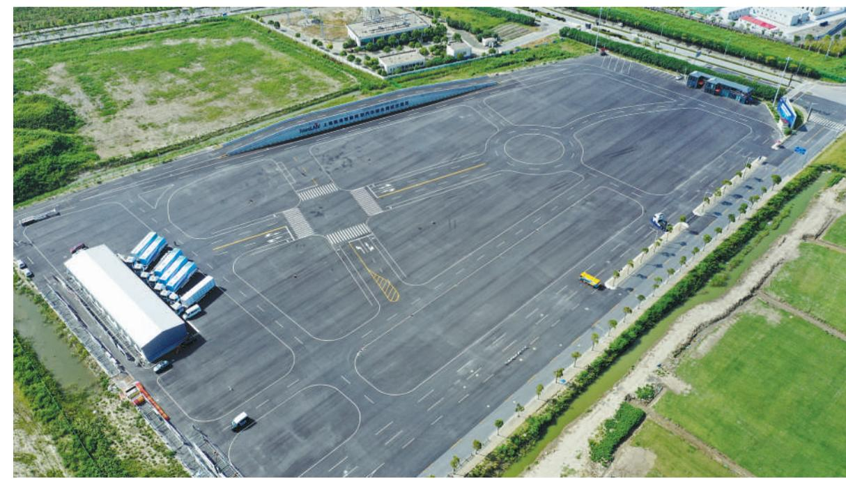
8月25日，上海临港智能网联汽车综合测试示范区，正在对汽车进行综合测试。8月23日，上海自贸区临港新片区挂牌后第一个重大项目——上海临港智能网联汽车综合测试示范区开园。未来这里将成为无人汽车、无人机、无人船等的综合测试场。截至目前，该示范区一期已建成并试运行，包括26.1公里开放测试道路、3平方公里封闭测试区及数据中心，并实现了区域内4G、5G网络全覆盖，初步构建了车路协同智能交通系统环境。
