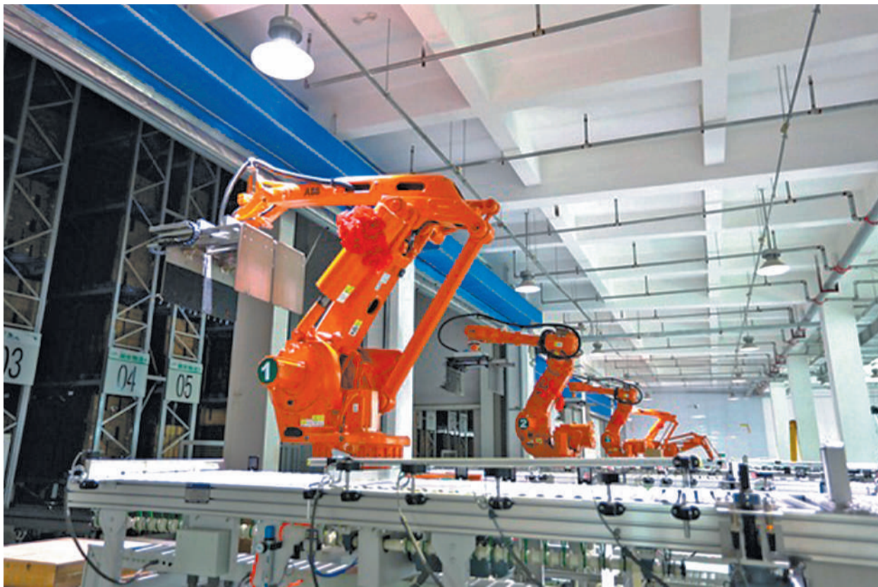
新时代健康产业集团物流中心引入了码垛机器人，可同时码放10种产品，每小时可码放400箱货物。本报记者 周雷摄
