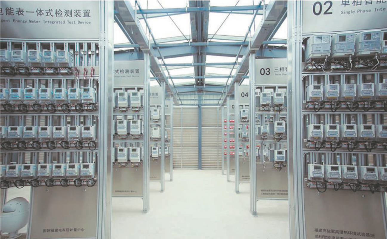
福建涠洲岛储能电站占地400平方米，由电池柜、变压器柜、监控柜及接入系统组成。图为放置在涠洲岛储能电站内的“单相智能电表一体式检测装置”。
