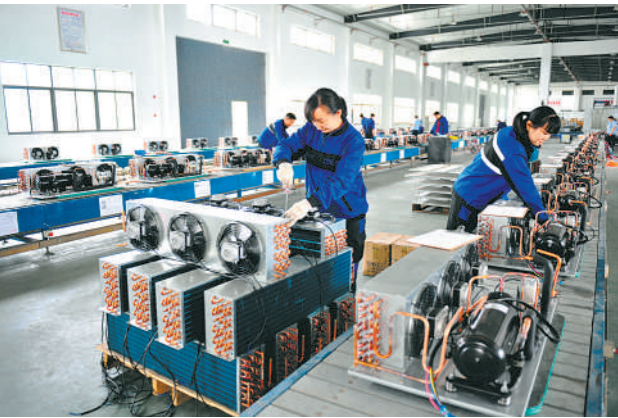
湖北省宜昌市夷陵区银岭冷冻设备有限公司工人在装配“集装箱式”移动冷库的制冷机组。该公司自主研发的制冷机组嵌入式一体化“集装箱式”移动冷库，可以到田间地头装货，解决了食品保鲜“最先一公里”问题。张国荣摄（中经视觉）
