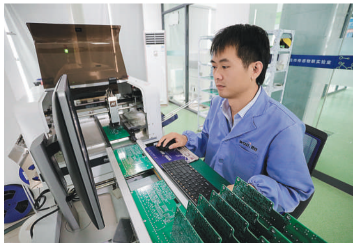
技术人员在传感物联实验室开展电快速脉冲群实验。 黄余洋摄(中经视觉)
