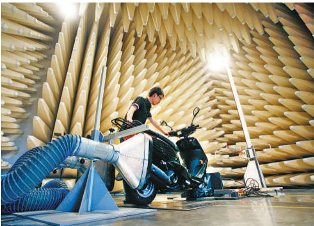
天津大学内燃机国家重点实验室内，学生正在进行降噪实验。 焦德芳摄 (中经视觉)
