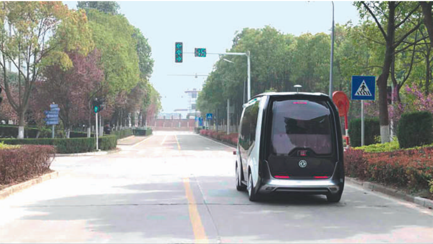
图为东风与华为共同研发的首款集成LTE-V/5G的无人驾驶汽车Sharing-VAN。该车不仅可以用于载客,还可应用在智慧物流、移动零售等场景。
