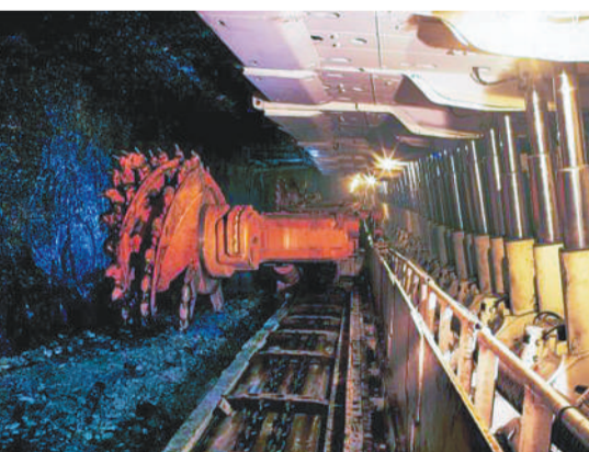
鄂尔多斯的煤炭综采现场。（资料图片）
