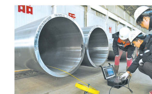
12月19日，河北省盐山县宏润核装公司的技术人员在检测用于核电站主蒸汽管道的1070毫米口径无缝钢管。该产品是目前采用辊挤压成形工艺生产的最大口径钢管，打破了国外产品的高价垄断。 傅新春摄
