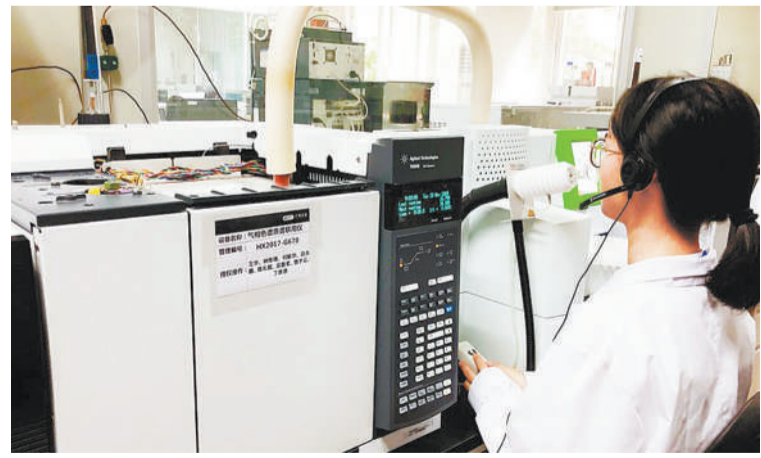
在广电计量化学分析实验室,气味评价师正利用气相色谱质谱联用仪和嗅辨仪对气味进行分离和嗅辨。郭静原摄
