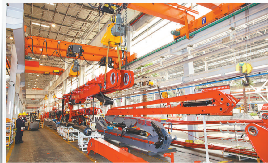
三一重工智能制造车间，工人远程操控臂架旋转智能吊具。
