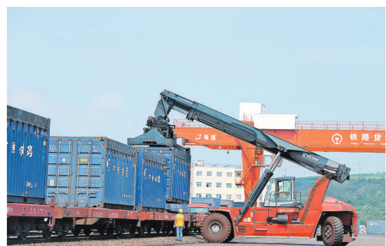
云南蒙自北站工作人员将满载铁矿石的集装箱从货物列车上卸下，再通过汽车运往钢铁企业。
