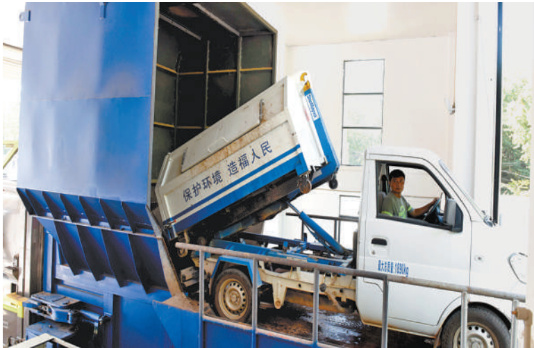
垃圾压缩中转站卸料大厅内,转运车把垃圾卸入压缩机器容器箱。
