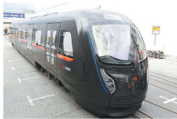
图为我国研发的新一代碳纤维地铁车辆。 邓旺强摄
