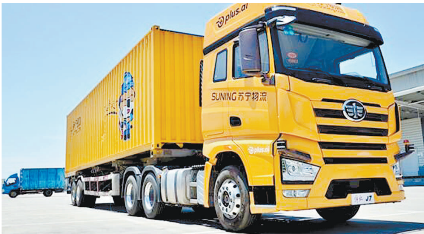
苏宁物流推出的国内首个40吨物流无人重卡在进行启动测试。
