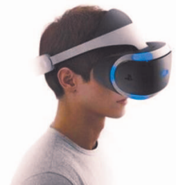
研究显示:影响VR设备用户体验的因素包括:设备重量、屏幕分辨率、可视角度、屏幕刷新帧数、交互方式、眩晕感以及内容。
