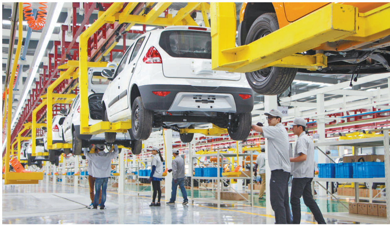
中科动力(福建)新能源汽车有限公司总装车间的底盘装配线。
