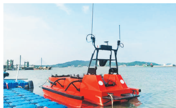
由中国人民解放军海军测绘研究所、国家海洋局南海调查技术中心与珠海云洲智能科技有限公司联合研制的M80B海底探测无人艇。
