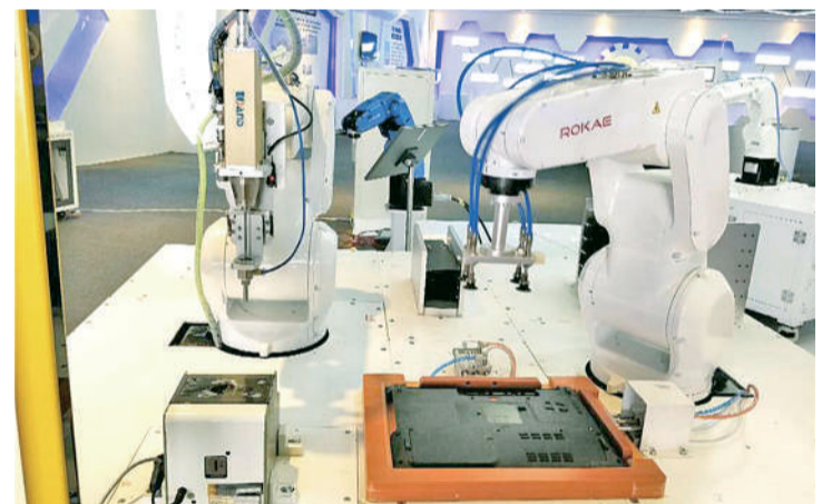
珞石研发生产的轻量级机器人广泛应用于3C领域。图为机器人在为电脑外壳装上零件。本报记者 周明阳摄
