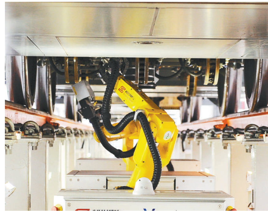
智能机器人检修动车
