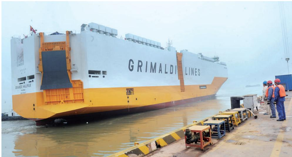
由江苏扬州金陵船舶公司建造的可载6700辆的滚装船在长江江苏扬州仪征段江边交付意大利船东。据介绍,该船共设13层甲板,应用了薄型钢板焊接新工艺、自动快速调节船舱层高等一批国内自主创新科技成果。
