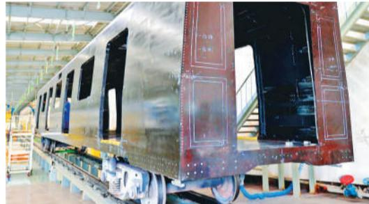
△中车长春轨道客车股份有限公司研制出具有完全自主知识产权的世界首辆全碳纤维复合材料地铁车体，车体较同类地铁金属车体减重约35%，其隔热性能是用金属车体装配车辆的1.5倍以上，最大限度地实现部件整合、零件整合。
