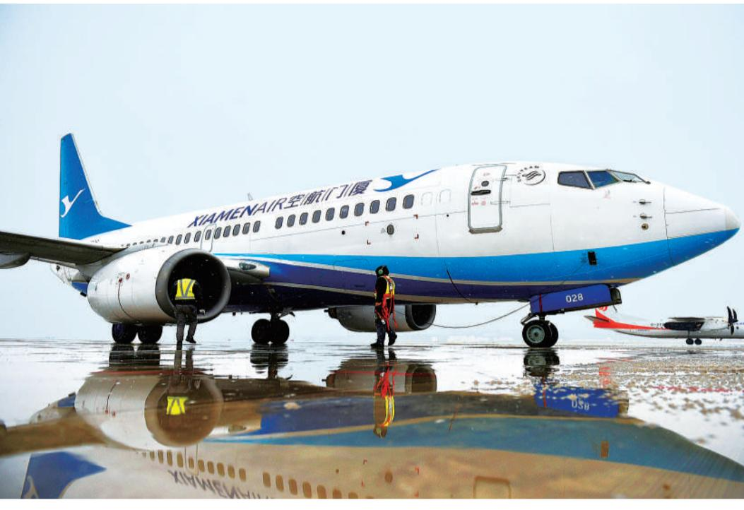
近日，宁夏迎来持续降雪、降温天气。低温、降雪天气下覆盖在飞机表面的降雪结成薄冰，会对机翼增加阻力、破坏空气动力结构，造成飞行安全隐患。图为1月4日，银川河东国际机场机务人员在除冰区对飞机进行检查。
