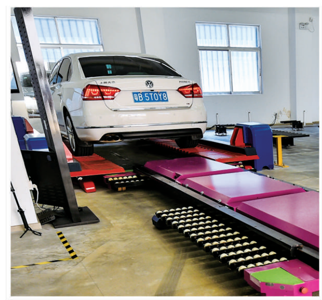
在深圳怡丰机器人科技有限公司，“激光导航+梳齿交换”式汽车搬运机器人准备搬运汽车。该类机器人被称为AGV自动引导运输车机器人。它利用了激光导航技术，定位精度误差少于5毫米。 新华社记者 毛思倩摄
