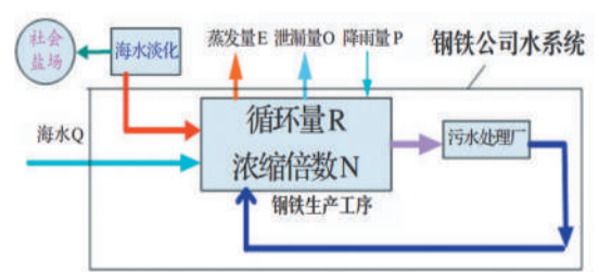
2017年重点用水企业水效领跑者工业废水耦合式零排放示意图
