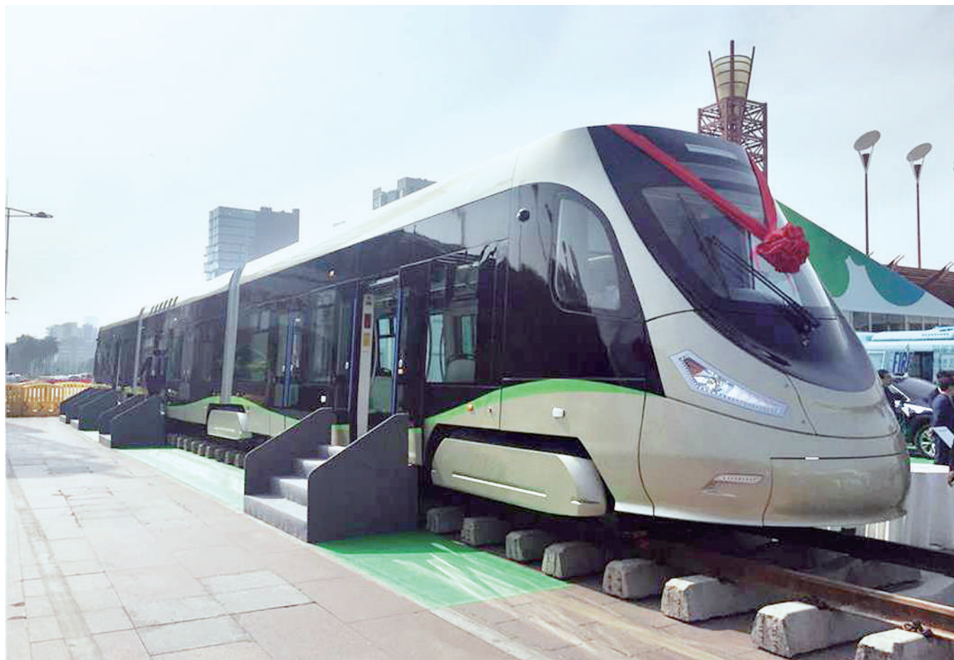
推介会上展示的中车青岛四方的氢燃料电池有轨电车。
