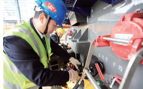
12月22日,武汉铁路局襄阳机务段工作人员为机车制动系统包扎保温套,强化安全防护。为确保冬季运输安全,该机务段从运输组织、设备整修维护等方面入手,加强车辆运输管理、现场作业安全检查力度。
