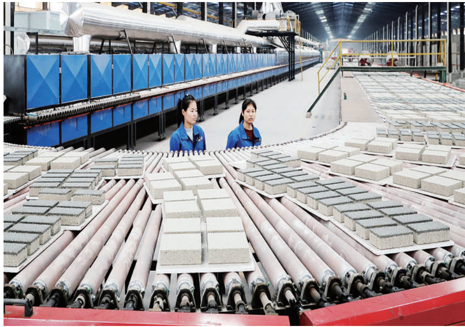
11月30日,在江西高安市建筑陶瓷产业基地,绿岛科技公司员工正在城市透水砖生产线上检查生产。该企业生产原料全部是陶瓷企业的陶瓷废砖,年处理废瓷砖20多万吨。 近年来,高安市持续践行绿色发展理念,按照“减量化、再利用、资源化”原则,以资源高效利用和循环利用为核心,引导工业企业从“吃干榨尽”向“变废为宝”转变,实现了陶瓷生产废料循环利用。 彭松林摄
