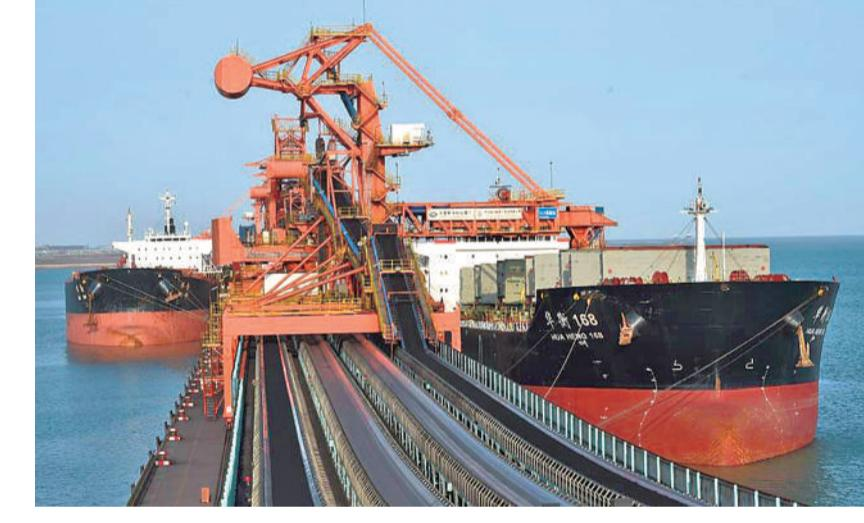
11月13日，货轮在黄骅港装载煤炭，传送煤炭用的皮带机上均装有除尘罩。近年来，神华黄骅港通过堆场防风网、压舱水回收、干雾除尘、翻车机洒水改造等环保项目，实现了煤炭装卸全过程抑尘，并运用多种手段治理含煤污水，建立起覆盖全港区的生态治理体系。
