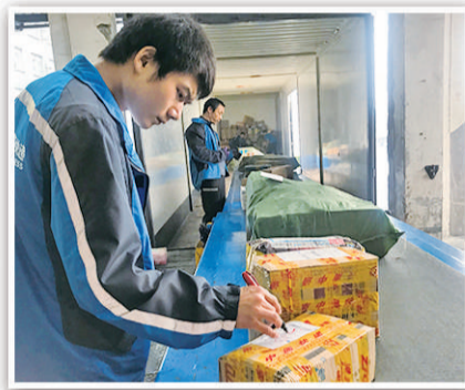
上图 顺丰快递公司的自动分拣机。 右图 在中通快递公司,快递员正在长达18米的伸缩卸货机上分拣快递包裹,大大提升了卸货效率。 吉蕾蕾摄
