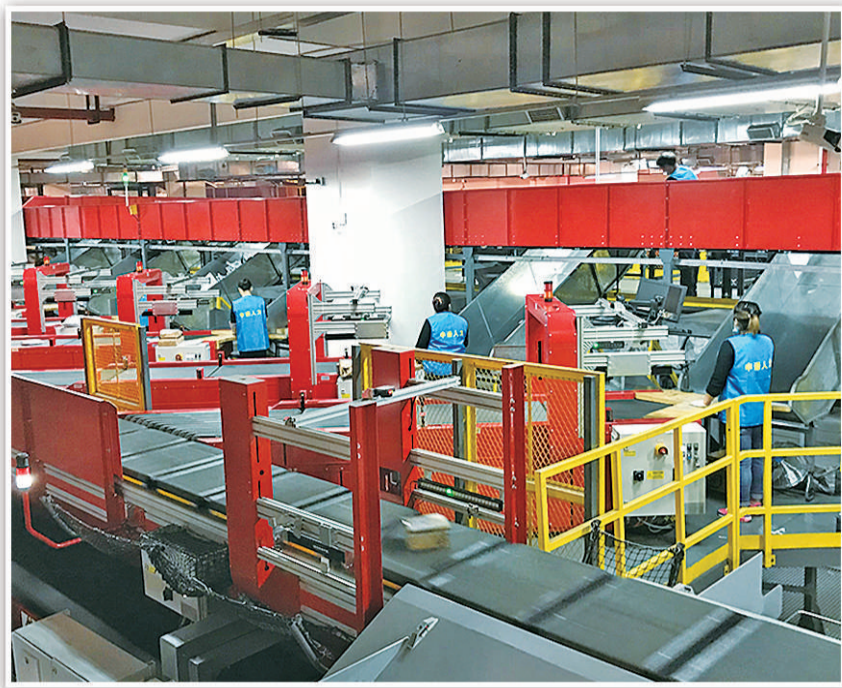
上图 顺丰快递公司的自动分拣机。 右图 在中通快递公司,快递员正在长达18米的伸缩卸货机上分拣快递包裹,大大提升了卸货效率。 吉蕾蕾摄
